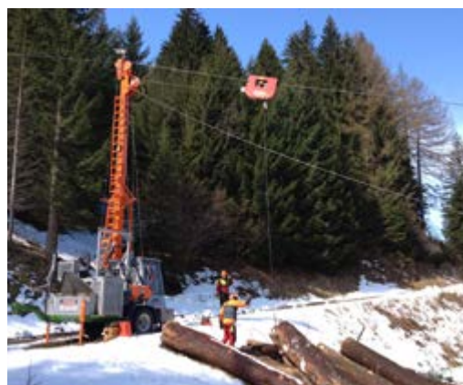
Des arbres abattus en montagne sont transportés vers la place d'entreposage à l'aide d'un câble-grue.
